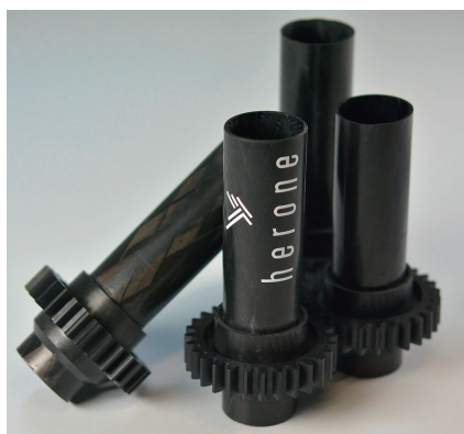
Bild 3. Antriebswellensystem, bestehend aus einem geflochtenen Vorformling aus thermoplastischen UD-Tapes mit Victrex AE 250 und angespritztem Zahnrad aus Victrex PEEK 90HMF40 (© herone)
