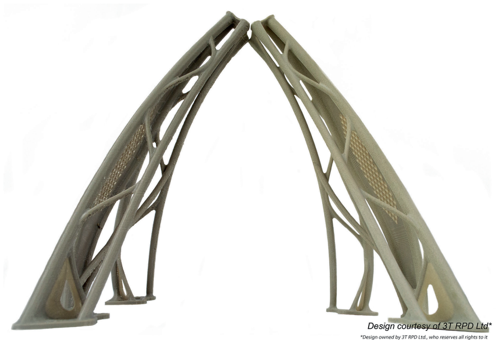
Additiv gefertigtes Versuchsbauteil einer Befestigung aus PAEK, links im Strangauftragsverfahren hergestellt, rechts mittels Lasersintern (© 3T-RPD)
